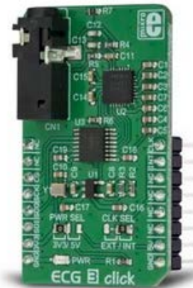
Bild 4. Die Click-Platine ist für den Einsatz auf einem System mit mikrobus-Anschluss geeignet und dient dem Prototyping. (Bild: RS Components)
