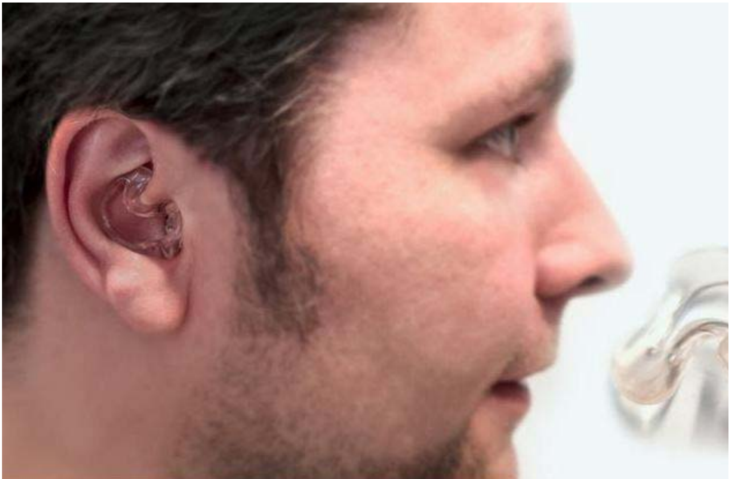
Bild 18. Der In-Ohr-Sensor für das nicht-invasive Schlag-zu-Schlag-Blutdruckmonitoring (Bild: Nadin Jurisch, Pressebild CiS Forschungsinstitut)
