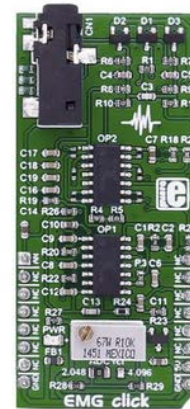
Bild 5. EMG-Click ist ein Prototyping-Board und keine medizinisch zugelassene Komponente (Bild: RS Components)
