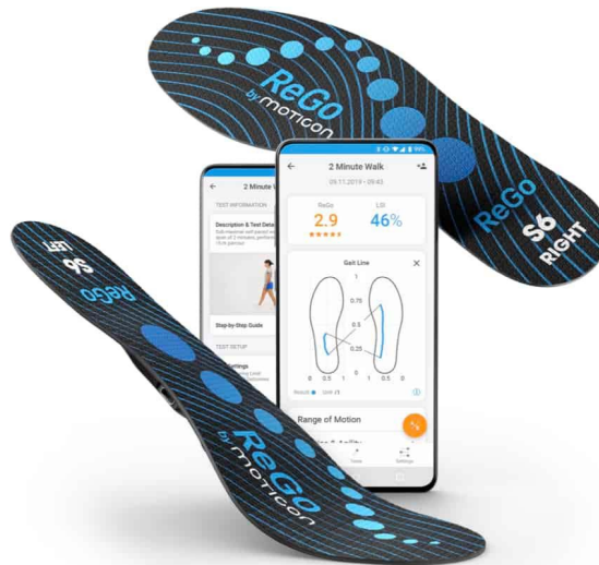
Bild 7. Die Datenerfassung wird durch die integrierte Bewegungserkennung ausgelöst (Bild: Pressebild Moticon ReGo AG)
