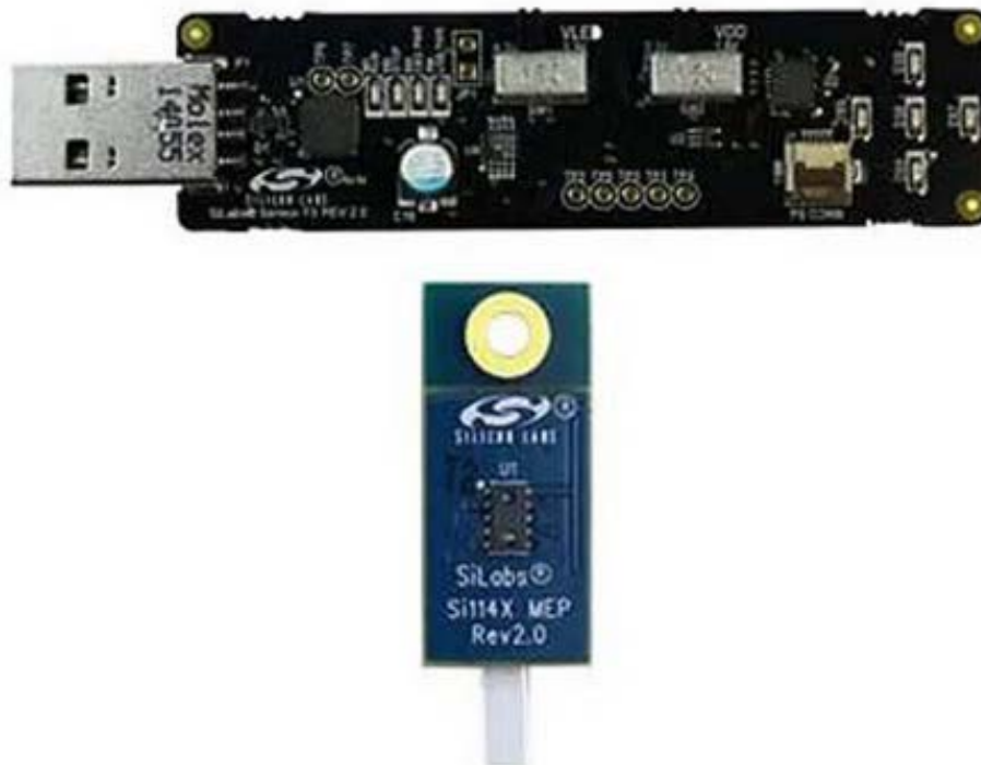
Bild 14. Das Evaluierungskit Si1145/46/47-M01 (USB-Tool-Stick) ebenfalls von Silicon Labs wird mit einer Programmier-Software geliefert. Damit kann auf Funktionen der optischen Sensoren (Si1145-M01, Si1146-M01 und Si1147-M01) zugegriffen werden. Mit dem Kit können auch Herzfrequenz- und Pulsoximetrie-Anwendungen realisiert werden. (Bild: RS Components)
