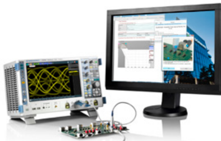
Bild 3. Mit der Option K58 für die Oszilloskope R&S RTO und R&S RTP lassen sich Tests für 1000BASE-T1 Single Pair Ethernet durchführen. (Bild: Rohde & Schwarz)
