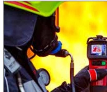
Altro fattore da considerare è la gamma di temperatura di uno strumento. Non tutte le applicazioni richiedono una gamma di misura tale da coprire livelli termici molto elevati. I dispositivi di imaging che offrono una gamma di temperatura più ampia utilizzeranno sensori più costosi, e questo si rifletterà sul prezzo dello strumento.
