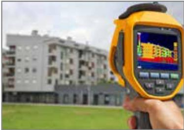
Gli strumenti progettati per l'uso in edifici in genere vengono utilizzati per rilevare i problemi all'interno della struttura e per risolvere problemi che potrebbero essere invisibili o dietro le pareti. Le possibili applicazioni includono il controllo dell'efficacia dell'isolamento, il rilevamento di umidità e perdite, il test degli impianti
