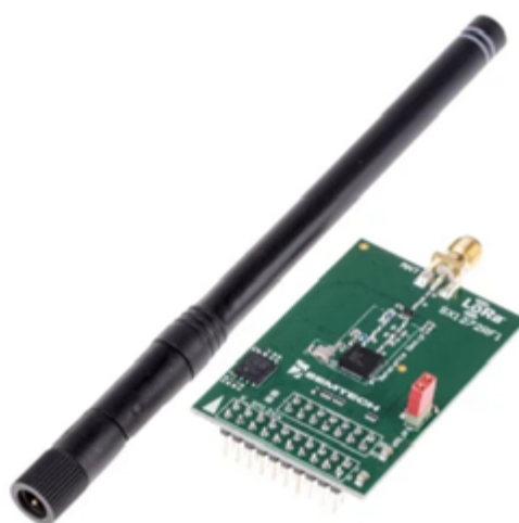
Fig. 4. Provmodul 868 MHz ISM-bandtransceiver för utvärdering från Semtech med LoRa-teknik. (Bild: RS)
