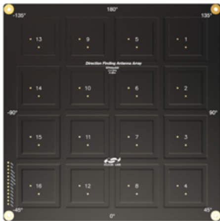
Fig. 6. Silicon Labs riktningssökande antensystem som används i SiLabs Bluetooth-riktningssöksystem. (Bild: Pressbild Silicon Labs)
