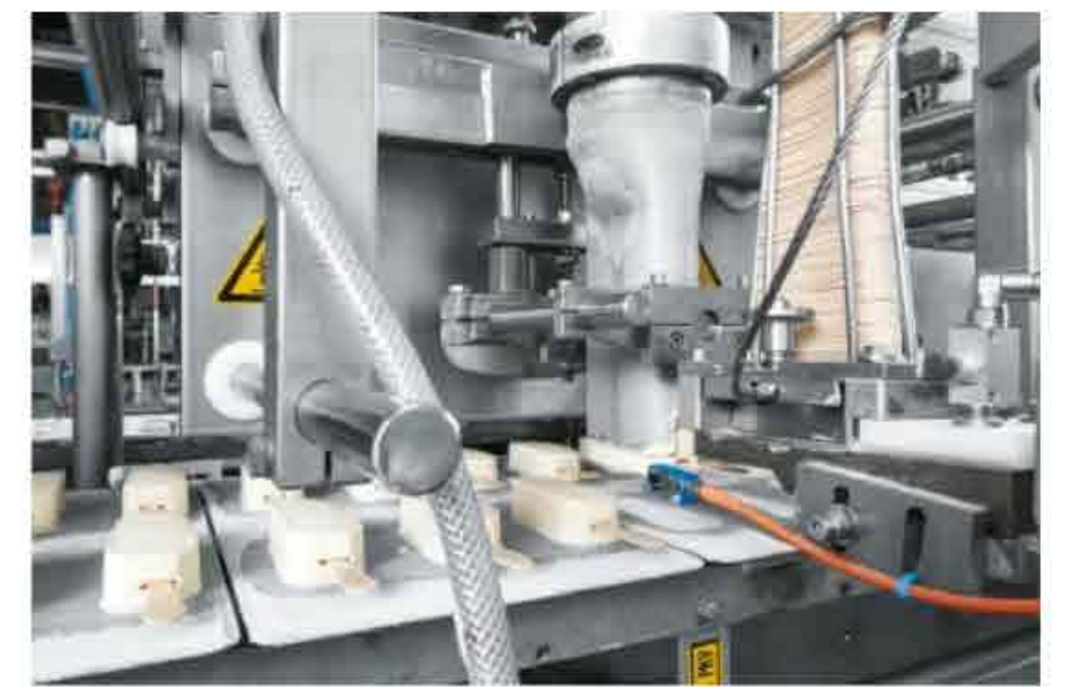
Perfekte Portionen: Der Extruder gibt einen Magnum-Kern pro Sekunde aus. Der Stiel wird während des Extrudierens in die Eiscreme eingeführt.
