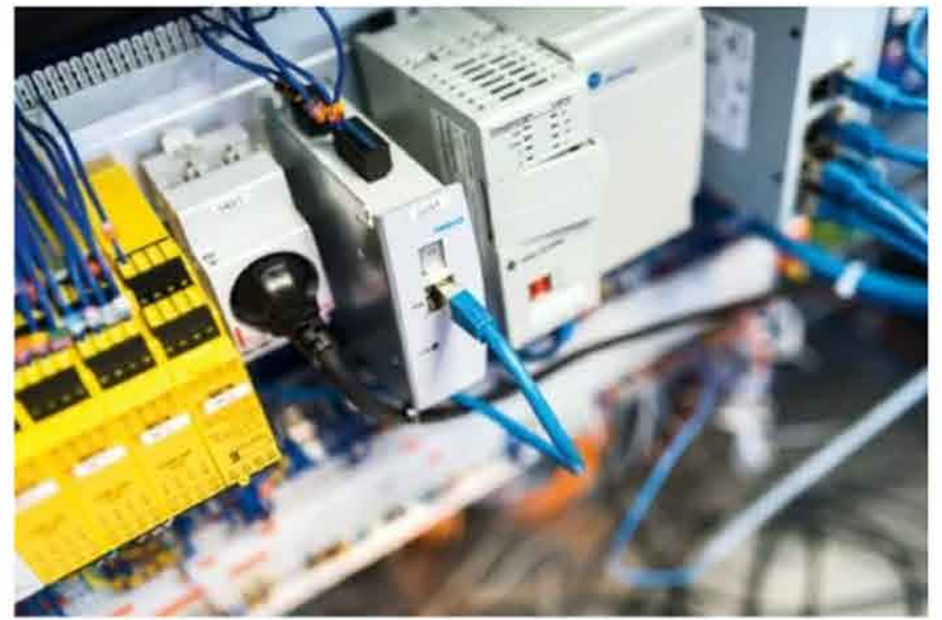
Klein aber fein: Der Controller CMMO steuert den Elektrozyylinder EPCO, der über IO-Link® angeschlossen ist
