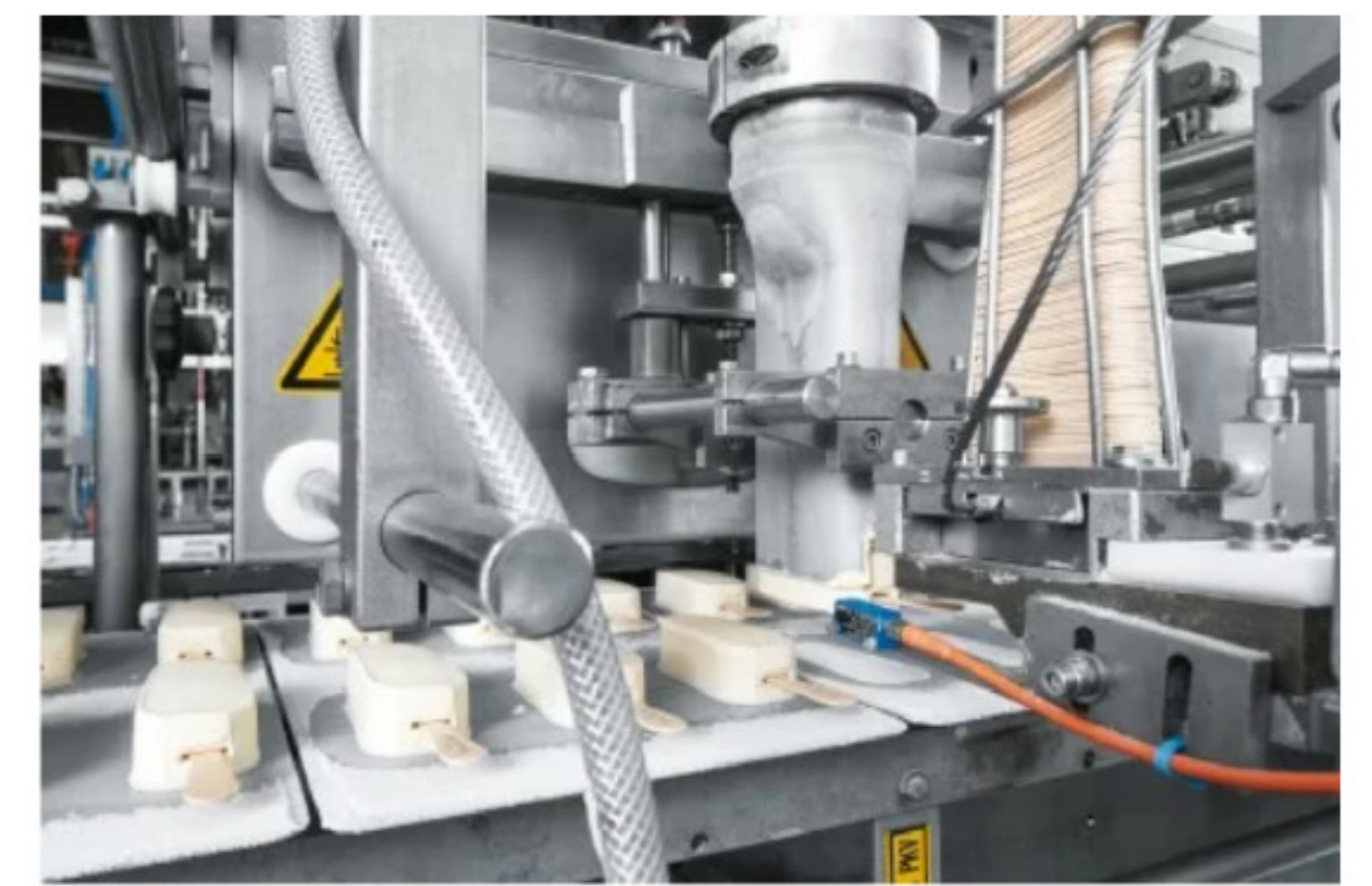
Portions parfaites : l'extrudeuse produit un noyau Magnum par seconde. Le bâton est inséré dans la crème glacée pendant l'extrusion.
