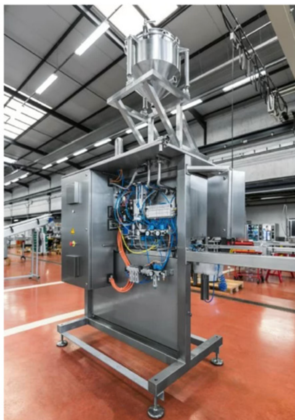
Toujours en processus d'assemblage : SF102 – Système de remplissage et d'étanchéité pour rondelles Doypack avec bouchon à vis
