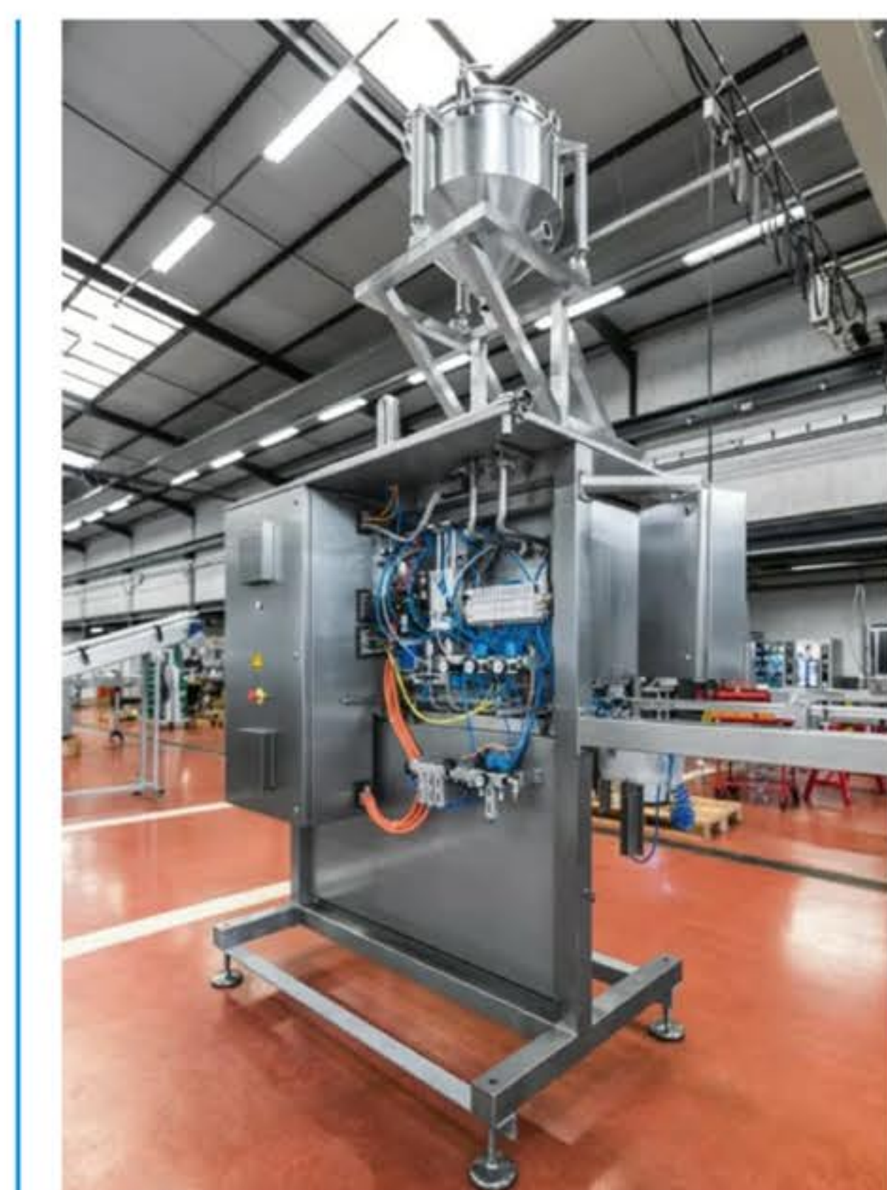
Stadig i monteringsprocessen: SF102 - Påfyldnings- og forseglingsystem til Doypack®-poser med skruelåg.
