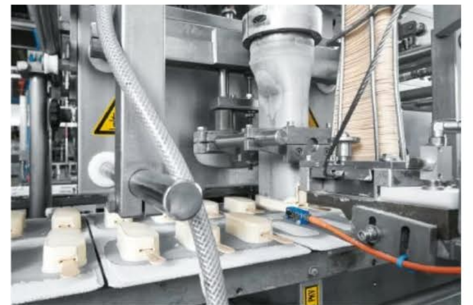
Extrudern producerar en Magnum-kärna per sekund. Pinnen förs in i isen under extruderingen.
