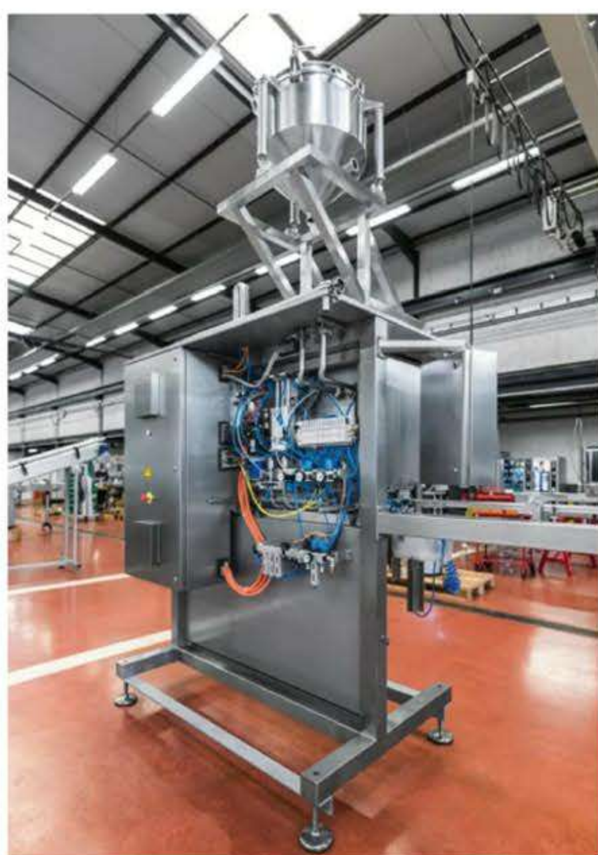
Este v štádiu montáže: SF102 - plniaci a uzatvárací systém pre vrecká Doypack so skrutkovacím uzáverom.
