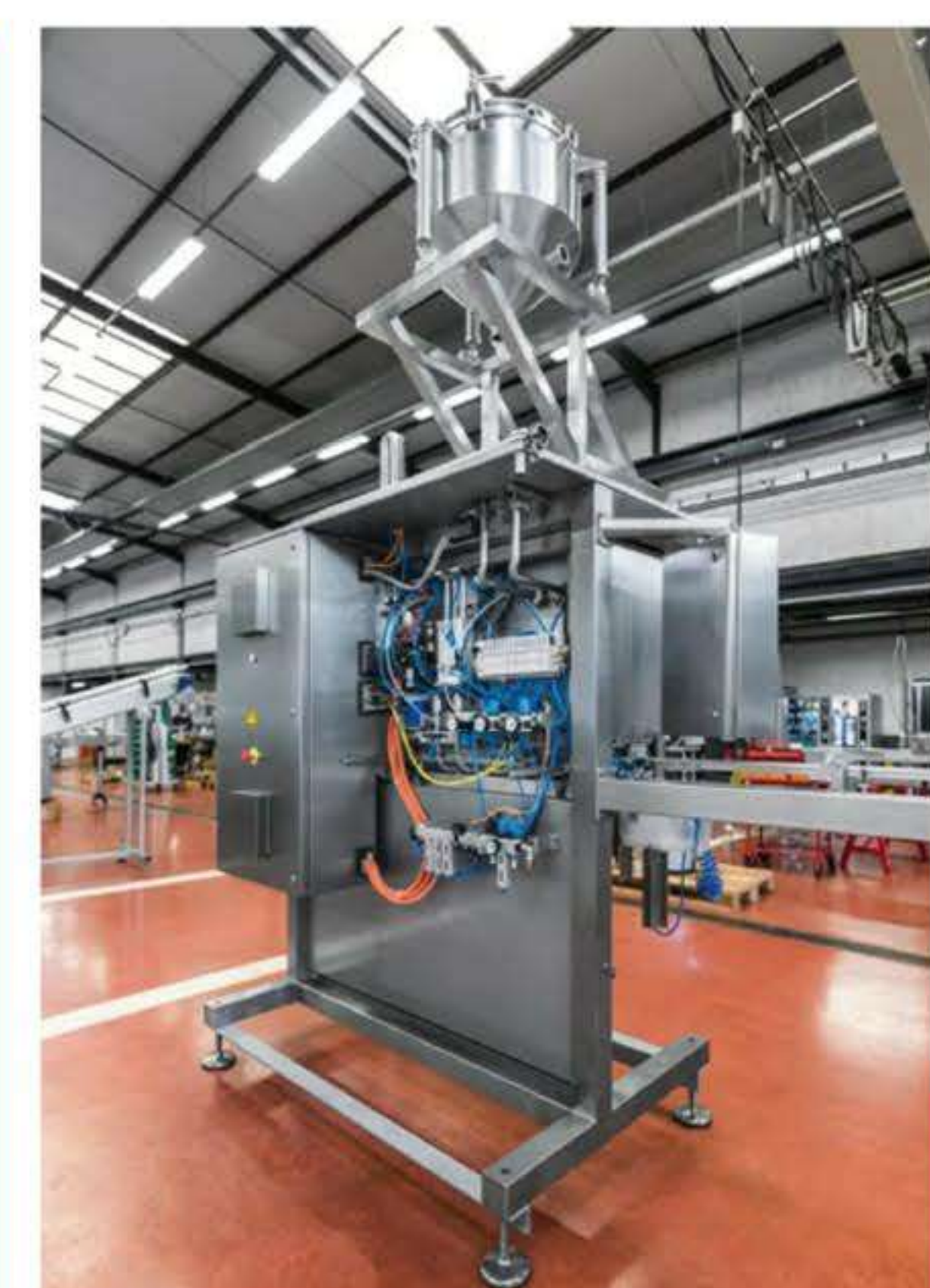
Wciąż w procesie montażu: SF102 — system napełniania i zamykania woreczków Doypack z zakrętką.
