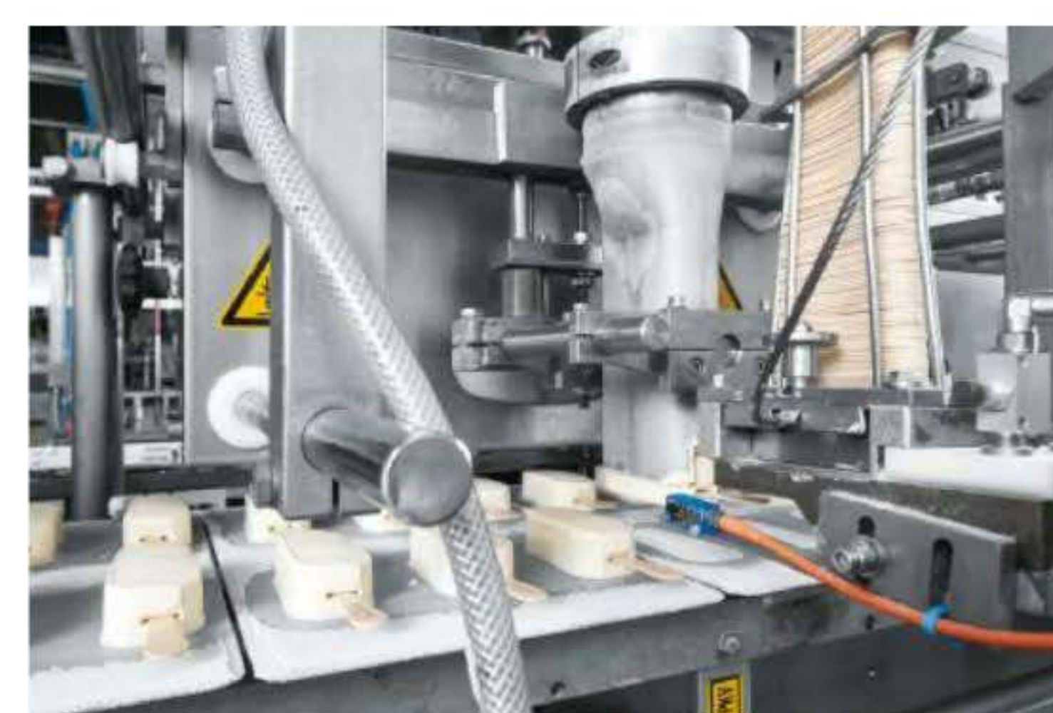
Ekstruder produkuje jedną porcję lodów Magnum na sekundę. Podczas wyciskania do lodów jest wkładany patyczek.
