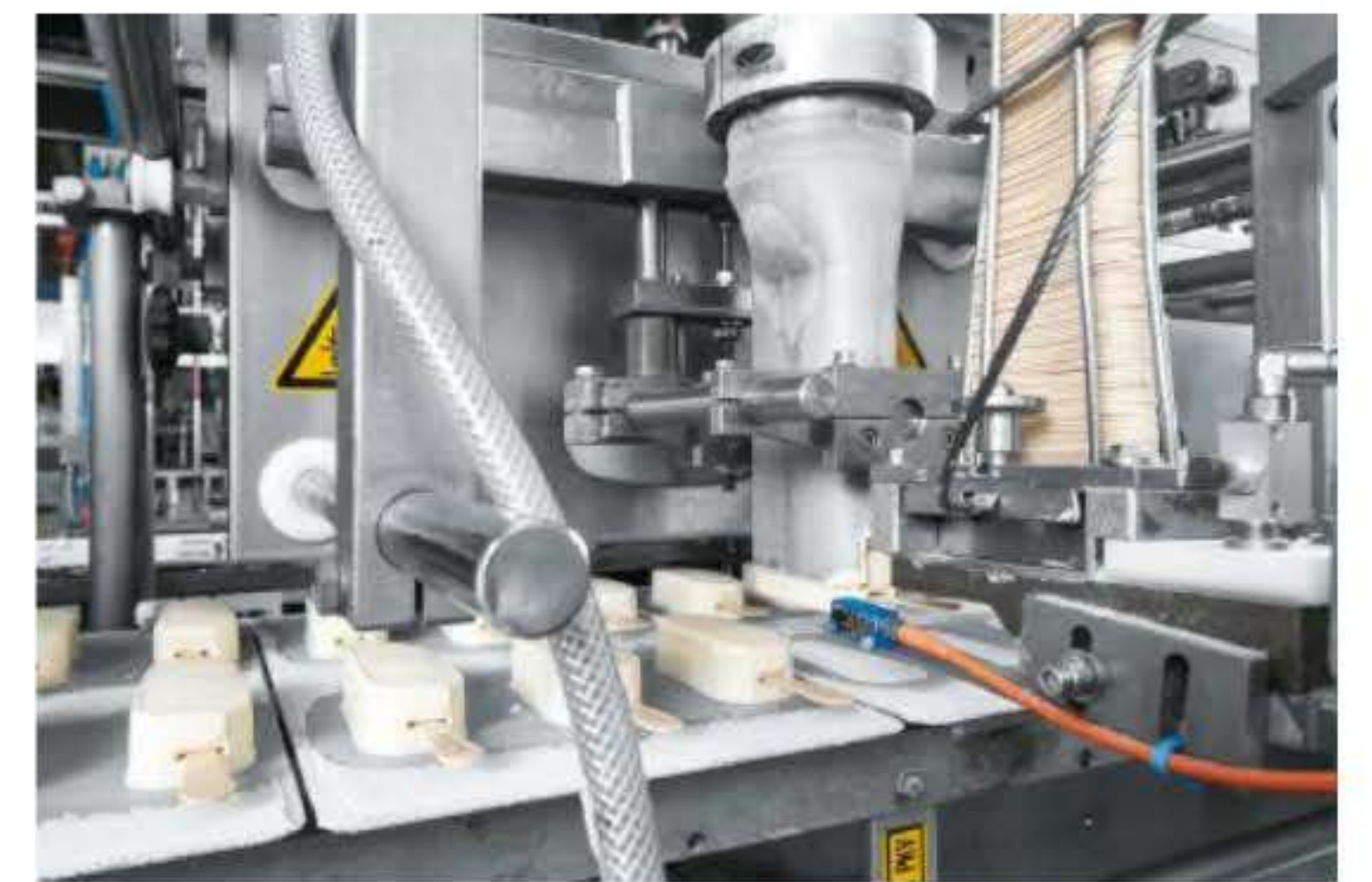
Tökéletes arányok: Az extruder másodpercenként egy Magnum-belső ad ki. A pálcika az extrudálás során kerül bele a jégkrémbe.
