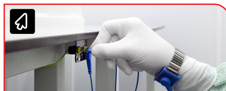
Mise à la terre ESD
