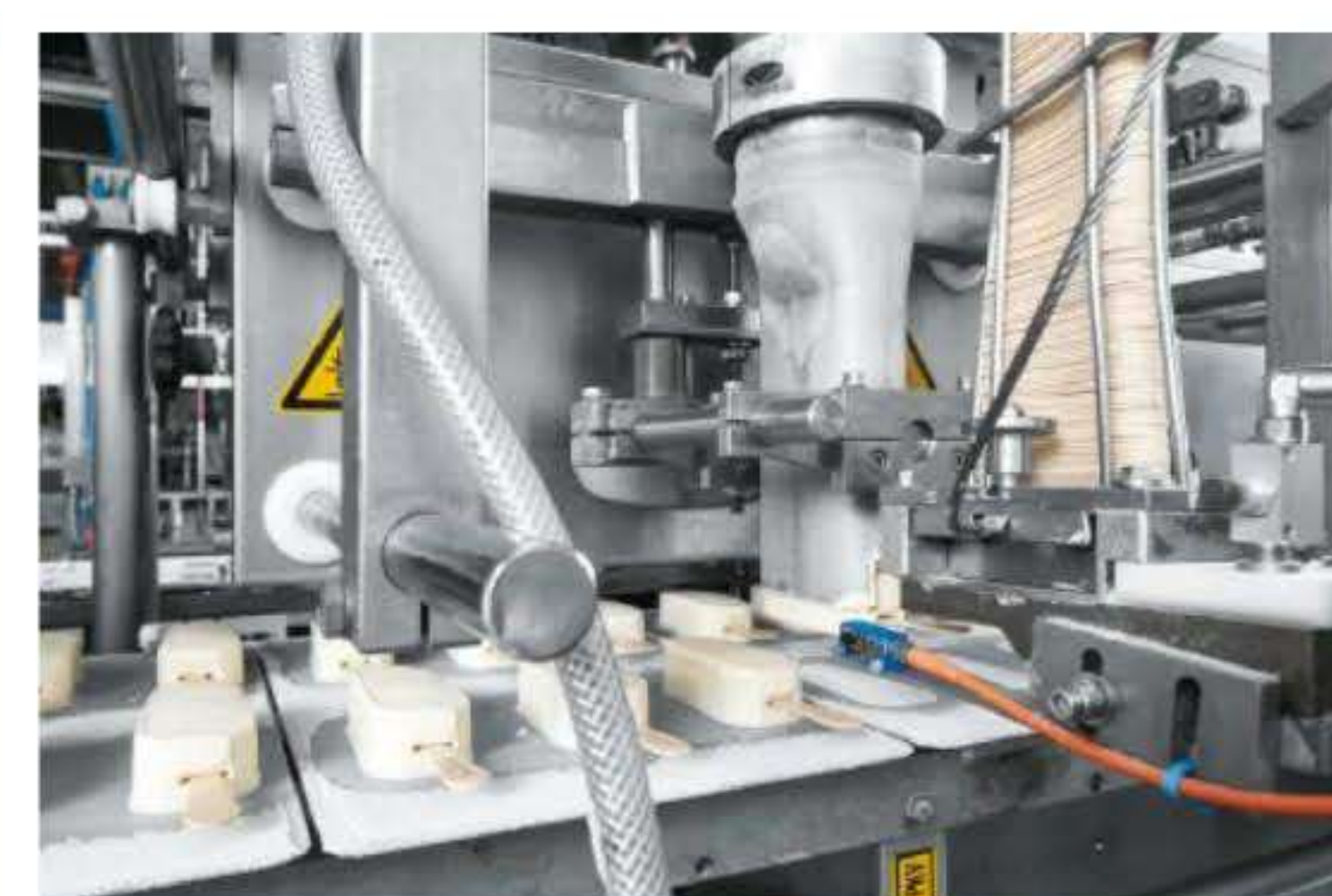
De extruder voert een Magnum-kern per seconde uit. Het stokje wordt gedurende de extrusie in het ijs gestoken.
