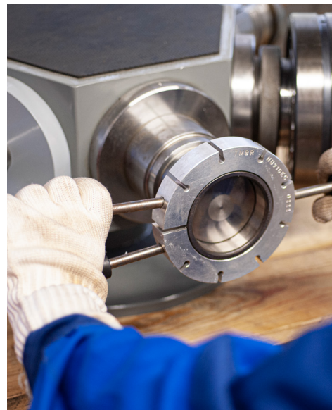
Rysunek 6: Demontaż łożysk w celu uniknięcia uszkodzeń.
