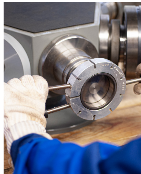
Obrázek 6: Demontáž ložisek pro zamezení poškození.
