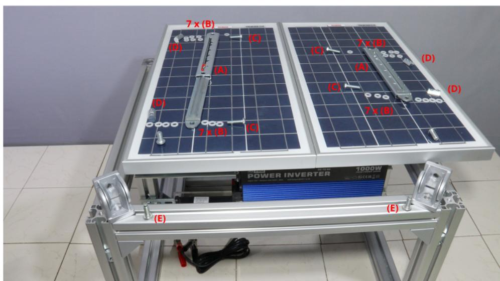
Zur Befestigung der mittleren Solarpanele an der Box müssen die Gelenke nochmal abgeschraubt werden.
