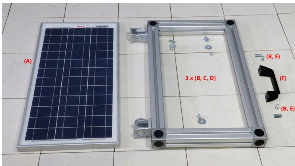
Auch hier werden die Schrauben und Unterlegscheiben zunächst nur leicht angezogen. Um die Panele zwischen Aluprofil und Unterlegscheiben schieben zu können, müssen die oberen beiden Schrauben zunächst in eine Ecke geschoben werden.
