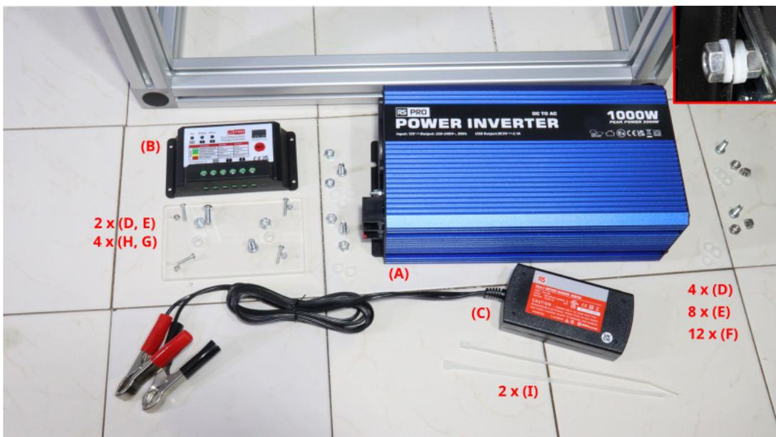
Zur Befestigung des Solarladers wird ein Reststück aus 6mm Acrylglas (681-665) zugeschnitten
