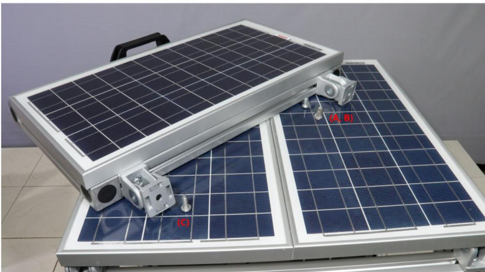
Zur Befestigung der rechten und linken Solarpanele an der Box müssen die Gelenke nochmal abgeschraubt werden.
