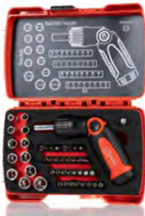
623-6441 1/4吋六角可逆棘輪刀頭驅動器，1/4吋Dr.sallow套筒（英制3/16吋、1/4吋、5/16吋、11/32吋、3/8吋、7/16吋，公制6、7、8、10、11、13mm），25mm長S2刀頭（一字3、4、4.5、5、5.5、6、7mm，Phillips#0、1、2、3，Pozi#0、1、2、3，Hex 1.5、2、2.5、3、4.5、5.5和6mm，防篡改Torx：T8、10、15、20、25、27、30、40），25mm套筒轉接器
