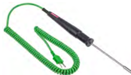
342-8962 直徑 6mm 尖端，表面探頭，-50°C 至 +600°C
