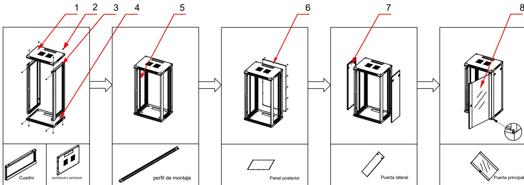
Montaje de la parte superior e inferior y marco con M5.5 \* 10 tornillo penetrante
