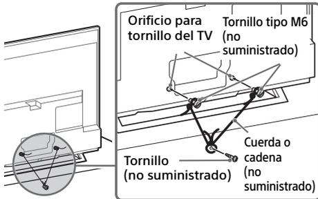
La longitud del tornillo tipo M6 varía en función del diámetro de la cuerda o de la cadena. Consulte la siguiente ilustración.
