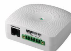
Tarjeta opcional: EMD (Dispositivo de monitoreo ambiental)
