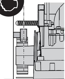
k - Comprobar que la distancia entre el piñón y la cremallera sea de 1÷2 mm. En caso contrario, para evitar que el peso de la hoja recaiga sobre el motorreductor, regular la altura del motor enroscando los tornillos de regulación
