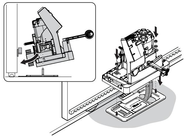
f - Verificar el correcto posicionamiento del motorreductor sobre la placa de cimentación
