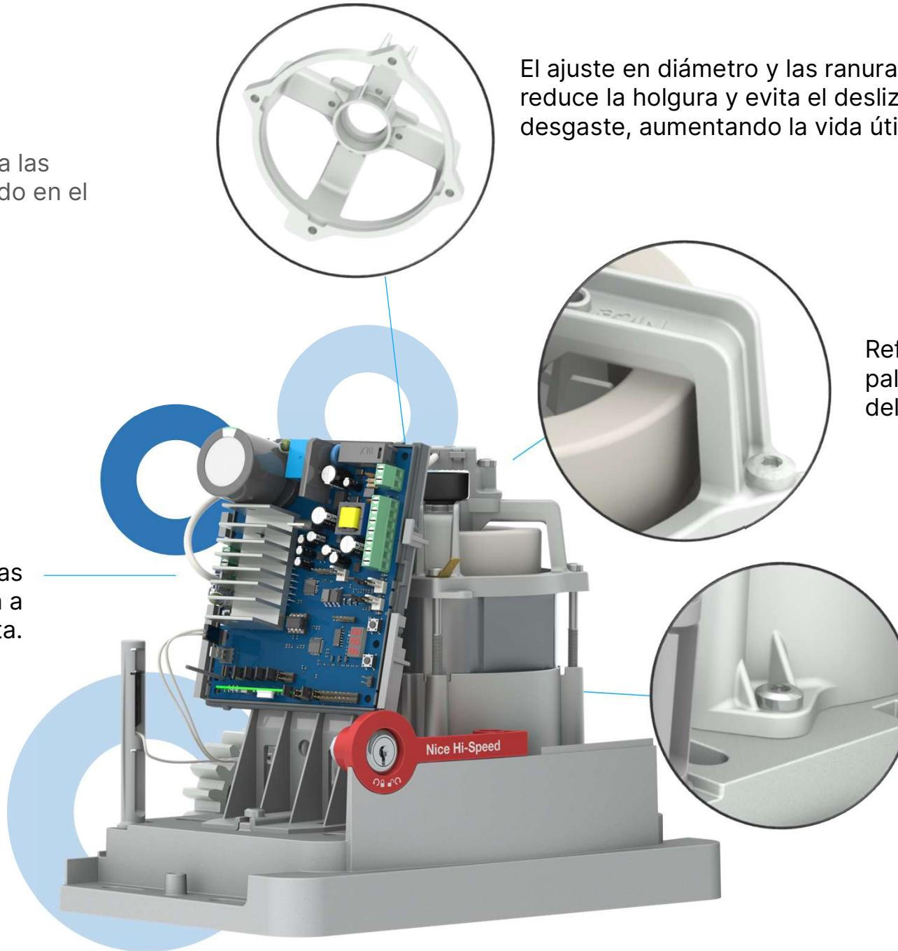
El ajuste en diámetro y las ranuras añadidas, reduce la holgura y evita el deslizamiento y el desgaste, aumentando la vida útil del conjunto.
