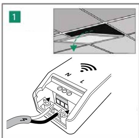
Retirez l'ancien luminaire et installez un nouveau. Reliez la phase, la terre et le neutre. Connectez les détecteurs\* et réglez les paramètres.
