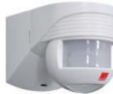
Montage mural. Puissance : 1000 W / 230V. Zone de détection 140° / 12 m Horizontale + 180° Verticale. Arrivée câble par-dessus/dessous ou arrière. Socle arrière couvrant et embrochable, IP44 / classe II / CE. Blanc.
