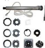
Moteur accompagné des principaux adaptateurs courants permettant le remplacement d'une motorisation existante pour rénover ou moderniser un volet roulant en utilisant l'axe d'enroulement existant.
