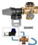
X-Cross est un groupe de sécurité multiposition pour chauffe-eau verticaux ou horizontaux d'une puissance maxi de 10 kW. Equipé d'un clapet anti-retour, d'une vanne d'isolement et d'une soupape tarée à 7 bar conforme à la norme
