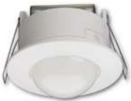
Puissance éclairage 1000W, 230V +10% / -15%, Ø de la zone de détection au sol : 6 m, IP21 (Protection classe II). Blanc. Détecteur 360°, Puissance 1000W
