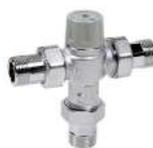
Mitigeur thermostatique Thermador Caleffi certifié NF. Température réglable de 30 à 50°C. Corps laiton chromé. Raccordement 3/4" M avec filtres et clapets anti-retour intégrés. Sécurité anti-brûlure. Débit maxi: 26 l/min (ΔP 1 bar)"
