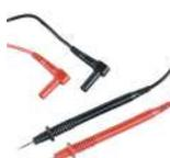
Jeu de cordons de mesure en silicone. CAT III 1000 V / CAT IV 600V - 10 A. Noir/Rouge. Température de fonctionnement -40° / +80°C. Fiche mâle coudée 90°. Pointes de touche type "lanterne" 4 mm. Isolement silicone.
