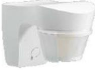
Montage en saillie ou au plafond, 2 modes de fonctionnement : Temporisé et commande d'une minuterie, 230 V~ +10/-15% IP55 (Protection classe II). Puissance 1500W. Blanc
