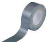
Ruban gris toilé, composé d'un tissu polyester recouvert d'un film en polyéthylène. Température d'utilisation : -20 à + 60°C. Température d'application : +10 à +40°C.
