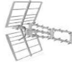
Gain 18Db max, filtre 4G LTE, rapport Av/Ar : 28 dB, angle d'ouverture 30°H. Longueur : 1050mm. Structure aluminium renforcée, canaux 21-60 UHF.
