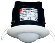
Détecteur de présence 1 canal 360° de détection sur un diamètre de 10 mètre au sol modèle faux plafond trou de perçage 63 millimètres
