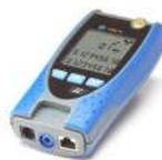
Testeur de continuités RJ45 / RJ12 / Coaxial F avec écran LCD et terminaison amovible.
