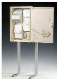
Coffrets de branchement provisoire triphasés (de type S20) prévus pour alimenter : des installations de chantier, des installations de fêtes foraines, marchés... des installations mobiles. Fixation : sur poteau ou sur piètement. Les compteurs triphasés sont fournis par ERDF lors de la mise en service. Les panneaux sont pré-câblés
