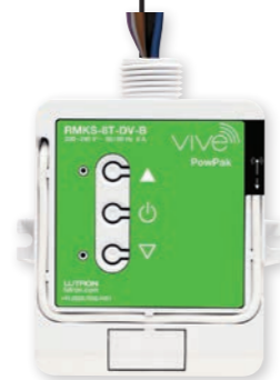
Module de contrôle sans fil Communique en radio et se monte sur une boîte de dérivation au plafond pour contrôler un groupe de lumières.
