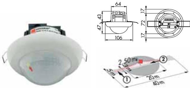
Détecteur de présence tout ou rien, surface spécialement adaptée aux couloirs 40 x 5 m de biais, 20 x 3 m de face, Ø8 m en vertical, pose apparente.
