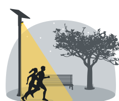
Sur détection de présence, la lanterne s'allume à pleine puissance.
