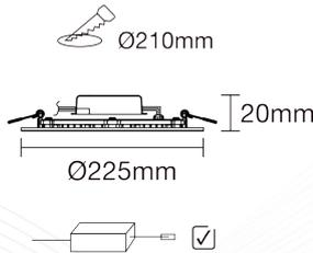
Downlight blanc extra plat en polycarbonate et aluminium, idéal pour l'éclairage des circulations. Sa garantie de 5 ans est un atout considérable pour les projets tertiaires.
