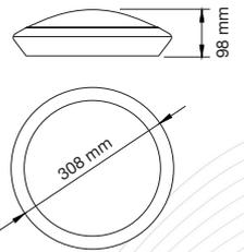
Hublot en polycarbonate renforcé. Il est équipé d'un switch, permettant de choisir la température de couleur à l'installation : 3000 ou 4000K. Son système de pose simplifié est spécialement conçu pour les chantiers à volume. Sa durée de vie de 50 000 heures est un atout considérable pour les projets tertiaires et industriels.
