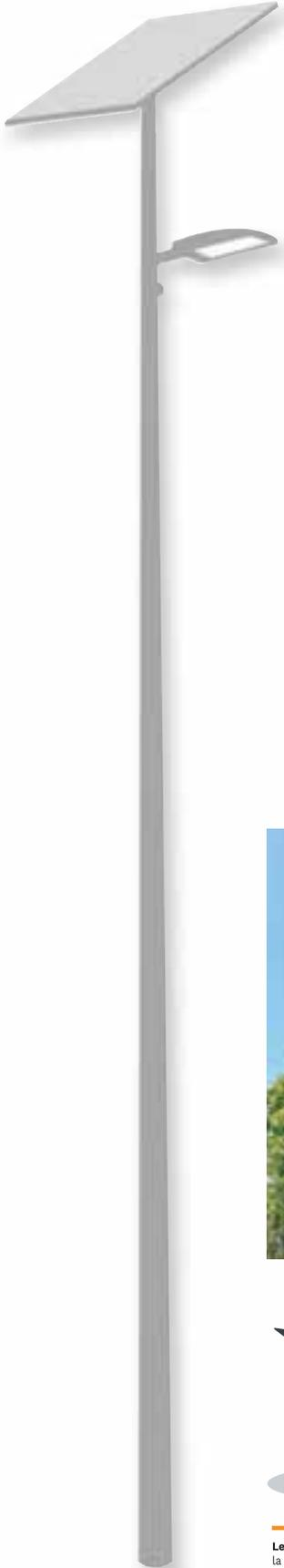
Le mât s'allume en début de nuit à un niveau Pmoy jusqu'à une heure définie H1, puis il abaisse son éclairage à puissance Pmin pour économiser l'énergie avant de se rallumer au niveau Pmoy à partir d'une heure définie H2 jusqu'au début de l'aube. A n'importe quelle heure de la nuit, en cas de détection de mouvement il s'allume à puissance Pmax pour un temps T, redéclenchable
