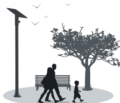
Le jour, le panneau solaire charge la batterie.
