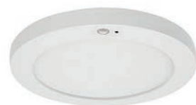
SIRA SENSOR AVEC DETECTEUR IR Montage apparent ou semi-encastré, Multi-puissance : 12, 15 ou 18W au choix via in- ter. 3000K, 4000K ou 6000K au choix via un inter. Diam.encastrement réglable 65 à 180mm IP23
