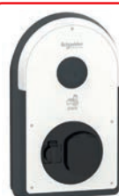
EVLINK PRO AC 1PH-7,4 KW-32A-1 PRISET2S+TE-RDC-DD 6 MA+RCD T Borne 7,4kW avec prise TE, détection 6mA, différentiel type Asi, bobine MNX & compteur MID
