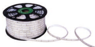
RUBAN LED 10 m 230V 15,5 W/m 4000K IP65 (non sécable) AVEC FICHE 2P+T, IP44, 1400 lm/m
