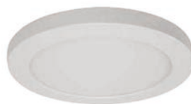
SIRA R downlight rond fixe 3 en 1. diam 225mm Montage apparent ou semi-encastré, Choix température couleur, 3000K, 4000K ou 6000K via interrupteur. Diam.encastrement réglable 65 à 180mm IP23
