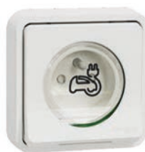
Mureva Styl - Prise courant 2P+T renforcée Encastrable - 16 A - IP55 - IK08 - EV - blanc
