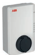
Borne Terra AC W22-S-R-0 mode 3 Jusqu'à 22kW en triphasé, RFID, Wifi, Bluetooth, OCPP 1.6
