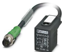
Câble pour capteurs/actionneurs, 3-pôles exempt d'halogène, connecteur mâle droit M12, détrompage: A, avec 1 LED, câblé avec Diode zéner, sur Connecteur de vanne B (10 mm), avec 1 LED, câblé avec Diode zéner, longueur de câble: 5 m
