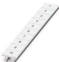
Ruban de repérage ZB, Rubans, blanc, repéré, repérable avec : CMS-P1-PLOTTER, impression transversale: numérotation continue 1 ... 10, 11 ... 20, etc. jusqu'à 91 ... 100, type de montage: encliquetage, pour bloc de jonction au pas de : 8,2 mm, surface utile: 10,5 x 8,15 mm, Nombre d'étiquettes: 10
