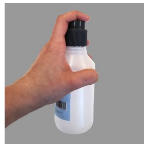
3. Visser le bouchon jusqu'à la butée et secouer pendant 15 secondes
