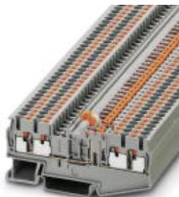
Bloc de jonction à couteau de sectionnement, Mode de raccordement: Raccordement Push-in, Section :0,14 mm<sup>2</sup> - 4 mm<sup>2</sup>, AWG: 26 - 12, Intensité nominale: 20 A, Tension nominale: 400 V, Longueur: 84 mm, Largeur: 5,2 mm, Coloris: gris, Montage: NS 35/7,5, NS 35/15
