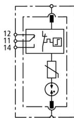
Schéma de principe du circuit DG S 75 VA FM
