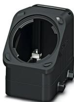
Capot passe-câble HEAVYCONNEX EVO en plastique, avec bride à baïonnette pour raccordement vissé EVO, B10, avec verrouillage transversal, hauteur 60,5 mm, sans raccordement vissé EVO
