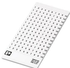
Carte de marquage, Feuille, blanc, repéré, longitudinal: numérotation continue 1 ... 10, 11 ... 20, etc. jusqu'à 91 ... (99)100, type de montage: collage, pour bloc de jonction au pas de : 3,81 mm, surface utile: 3,81 x 2,8 mm, Nombre d'étiquettes: 14
