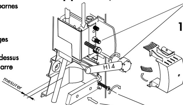
14 Si la mesure est supérieure à 17 mm, **couper** les prédécoupes du capot de bornier correspondant aux valeurs mesurées.
