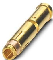
Contact à sertir, Connecteur femelle, tournés, diamètre de contact: 2 mm, zone de sertissage: 1,5 mm<sup>2</sup> ... 4 mm<sup>2</sup>, L'article est sans plomb, conformément à la directive RoHS II, sans exception 6c (Pb < 0,1 %)
