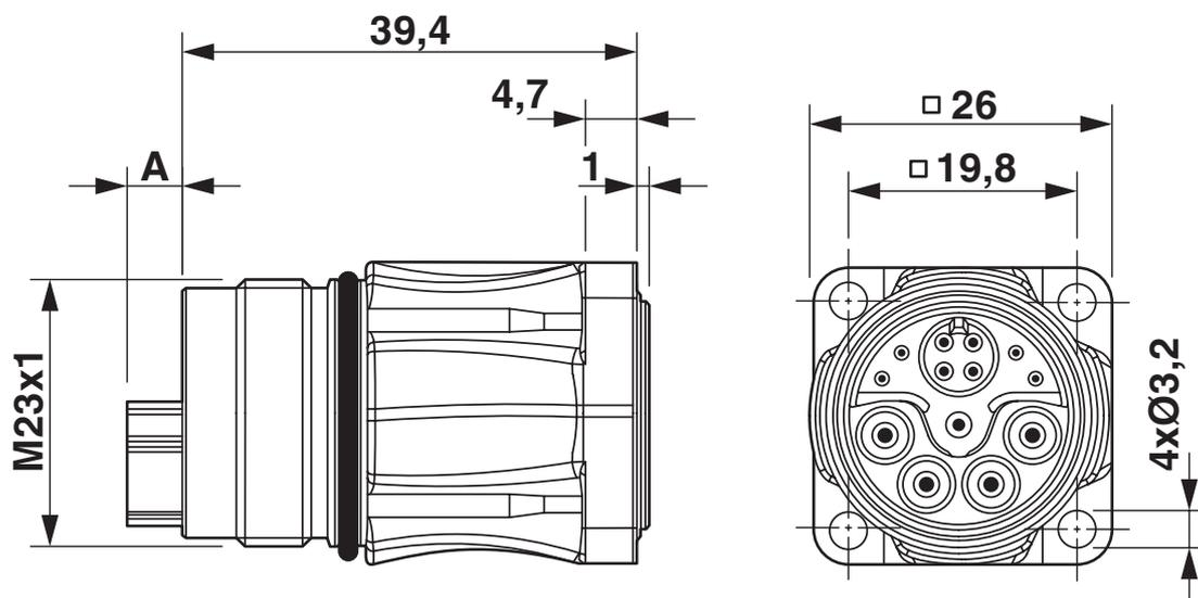
Type de connecteur mâle : dimension A = 4,75 mm, type de connecteur femelle : dimension A = 0 mm
