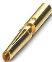
Contact à sertir, Connecteur femelle, tournés, diamètre de contact: 0,8 mm, zone de sertissage: 0,34 mm<sup>2</sup> ... 0,5 mm<sup>2</sup>, L'article est sans plomb, conformément à la directive RoHS II, sans exception 6c (Pb < 0,1 %)
