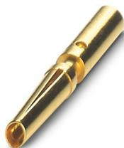
Contact à sertir, Connecteur femelle, tournés, diamètre de contact: 0,8 mm, zone de sertissage: 0,06 mm<sup>2</sup> ... 0,34 mm<sup>2</sup>, L'article est sans plomb, conformément à la directive RoHS II, sans exception 6c (Pb < 0,1 %)
