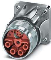
M23, Embases paroi avant, série: SH, droit, blindé: oui, Pour verrouillage standard et SPEEDCON, Nombre de pôles: 4+4+4+PE / 3+N+PE, Sens de rotation: standard, type de contact: Connecteur femelle, Raccordement à sertir, Joint torique axial, 4x Ø 3,2, cote de bride: 26 mm x 26 mm, détrompage: N
