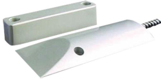
Détecteur à contact magnétique pour portes basculantes, boîtier aluminium moulé sous pression, avec câble de sortie protégé par gaine métallique. Dimensions : 62x105x20mm.
