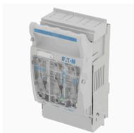
**Interrupteur-sectionneur, Basse tension, 160 A, AC 690 V, NH00, AC23B, 3P, IEC, borne pour montage par le haut, borne à cosse**
