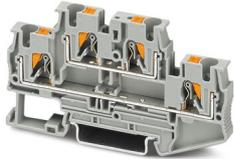
Bloc de jonction à deux étages, tension nominale: 500 V, intensité nominale: 28 A, type de raccordement: Raccordement Push-in, 1er et 2e étage, Section de référence: 4 mm<sup>2</sup>, section : 0,2 mm<sup>2</sup> - 6 mm<sup>2</sup>, type de montage: NS 35/7,5, NS 35/15, coloris: orange
