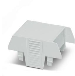
Boîtier électronique sur rail DIN, Partie supérieure du boîtier, design haut, ouverture de raccordement d'un côté, Ouverture de raccordement unilatérale, largeur: 45,1 mm, hauteur: 75,26 mm, profondeur: 36,95 mm, coloris: gris clair (7035)
